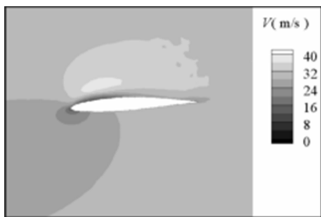
شکل ۱۳) کانتور جریان در مقطع ۰/۸ از پهنای بال، ۳۰ متر بر ثانیه و زاویه حمله ۱۵ درجه برای هندسه ساده و هندسه با مولد گردابه؛ (الف) هندسه ساده، (ب) هندسه با مولد گردابه
