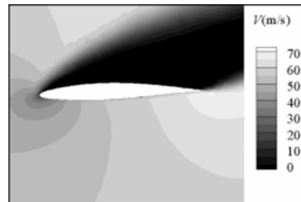
شکل ۷) کانتور جریان هندسه ساده در ۶۰ متر بر ثانیه برای زوایای حمله: الف) ۵، ب) ۱۰، ج) ۱۵، د) ۲۰ درجه
