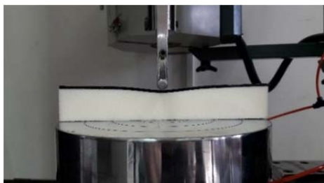
شکل ۶) ساختار ساندویچی حین تست تورفتگی
