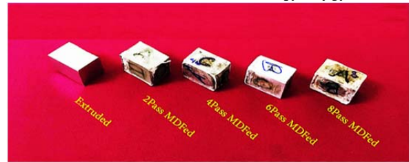
شکل ۴) نمونه‌ها پس از عبورهای مختلف MDF
