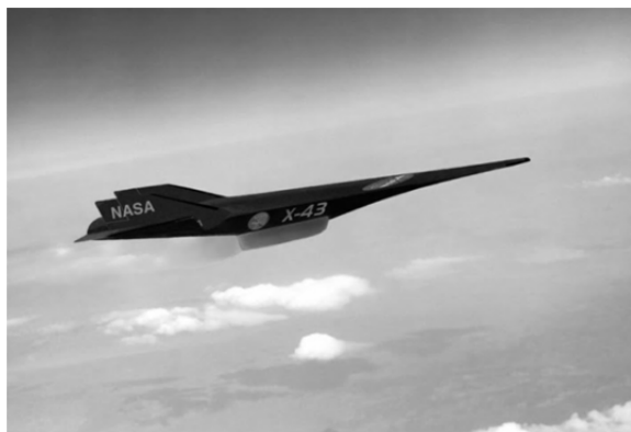
شکل (۱) پرنده ایکس-۴۳ ناسا با موتور اسکرم‌جت [6]
