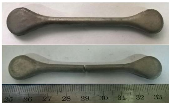
شکل ۴) نمونه ساخته‌شده با پارامترهای بهینه، قبل و بعد از آزمون کشش
