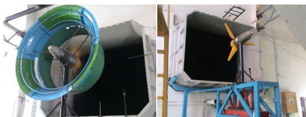
شکل ۶) چگونگی قرارگیری TMWT در دهانه تونل باد
