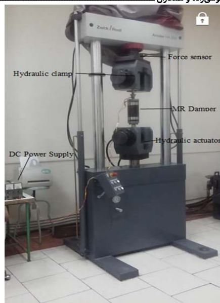
شکل ۳) مجموعه تست آزمایشگاهی تست دمپر مگنتورئولوژیکال
