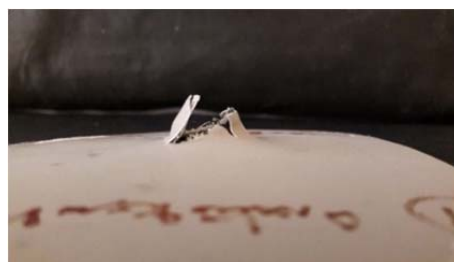
شکل ۱۵) نمای جانبی یکی از نمونه‌های سری دوم پس از برخورد
