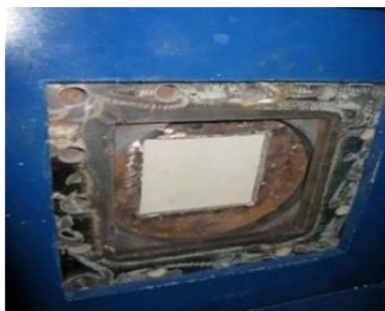
شکل ۵) محل قرارگیری هدف در فیکسچر
