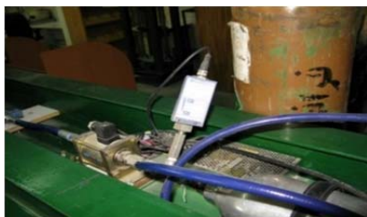
شکل ۴) فشارسنج دیجیتالی سیلندر و شیر سلنویید
