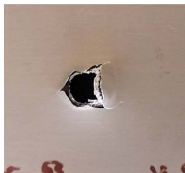
شکل ۱۴) نمای پشت یکی از نمونه‌های سری دوم پس از برخورد
