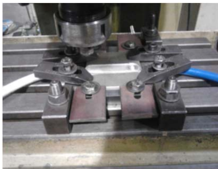
شکل ۱) تصویر نگهدارنده مجهز به سیستم آنگرد برای انجام جوشکاری
