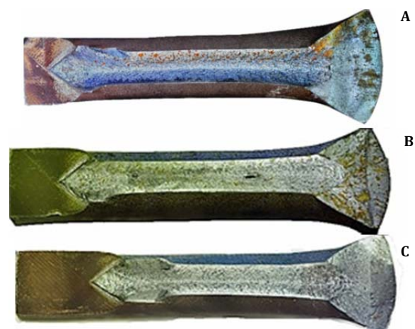
شکل ۱۷) نمای کلی سطح شکست نمونه آزمایش خمش سه‌نقطه‌ای با شیار شورون (A) ۵/۱، (B) ۱۰، (C) ۱۵ میلی‌متر
