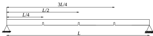
شکل ۳) محل قرارگیری ترک در تیر
