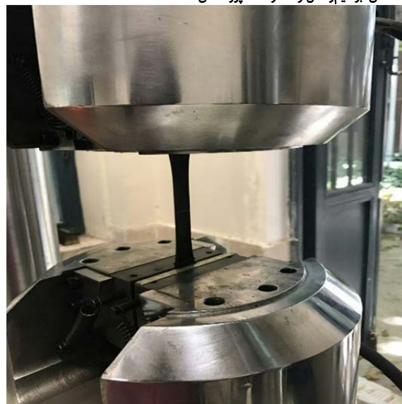
شکل ۹) نمونه نانوکامپوزیتی درون دستگاه تست خستگی
