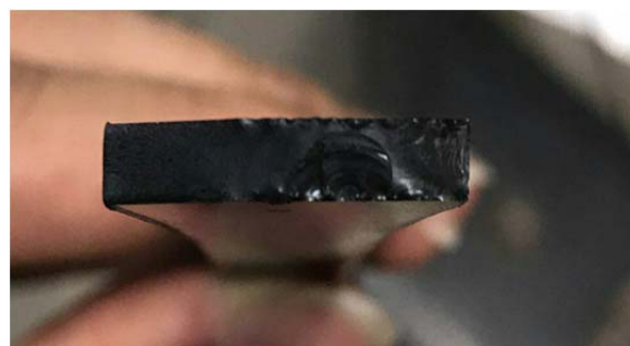
شکل ۱۰) تصویر مقطع شکست نمونه نانوکامپوزیتی
