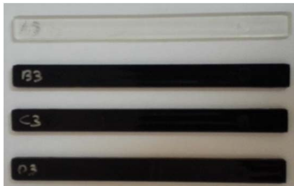
شکل ۳) نمونه‌های آزمون جذب آب
