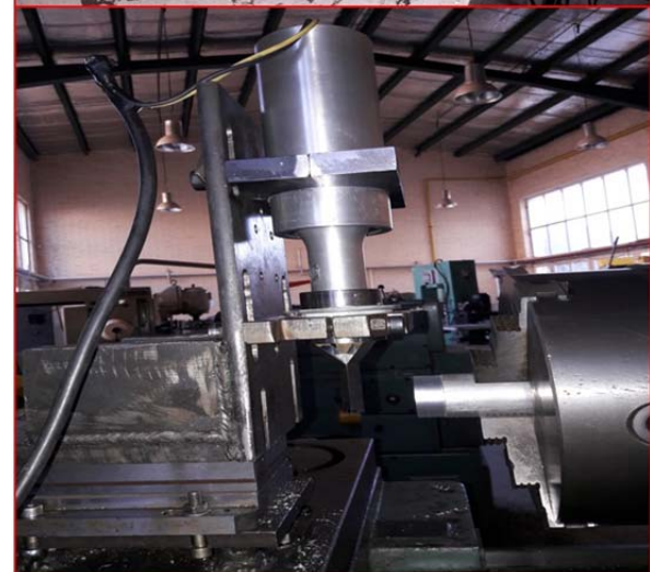
شکل ۷) ابزار UVT و تنظیمات اولیه آزمایش
