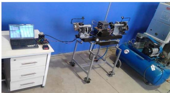
شکل (۴) تجهیزات برای فرآیند شکل‌دهی داغ لوله با دمش‌گاز همراه با تغذیه محوری
