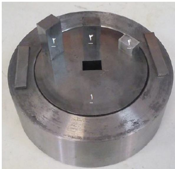
شکل ۲) تصویر قالب MDF و سنبه های تهیه شده برای پژوهش حاضر؛ ۱) قالب، ۲) سنبه بزرگ، ۳) سنبه کوچک، ۴) نمونه
