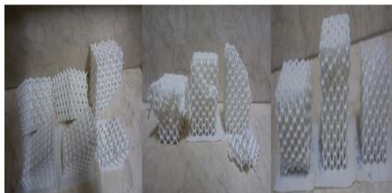
شکل ۴) به ترتیب از راست نمونه‌های کلوین ۷-۸۹، ۷-۸۵، ۷-۸۱، ۱۰-۸۹، ۱۰-۸۵، ۱۰-۸۱، ۱۵-۸۹، ۱۵-۸۵، ۱۵-۸۱ پس از آزمون فشار
