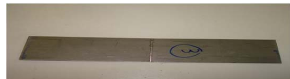
شکل ۳) نمونه جوشکاری شده به‌روش لیزر پالسی
