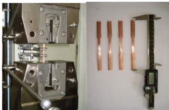
شکل ۴) نمونه‌های ساخته شده برای انجام تست کشش
