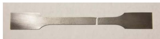
شکل ۸) نمونه آزمون کشش آب‌بند مکانیکی لامینار پس از شکست
