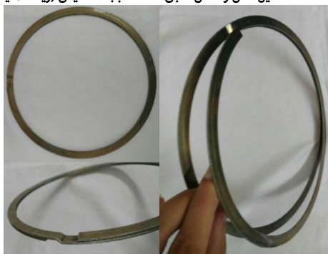
شکل ۱۰) نمونه آب‌بند مکانیکی لامینار ساخته شده
