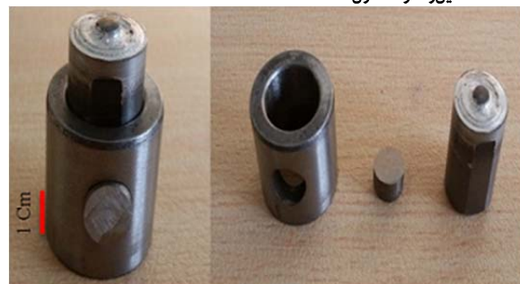
شکل ۳) مونتاژ و دموونتاژ ابزار جوشکاری اصطکاکی اغتشاشی
