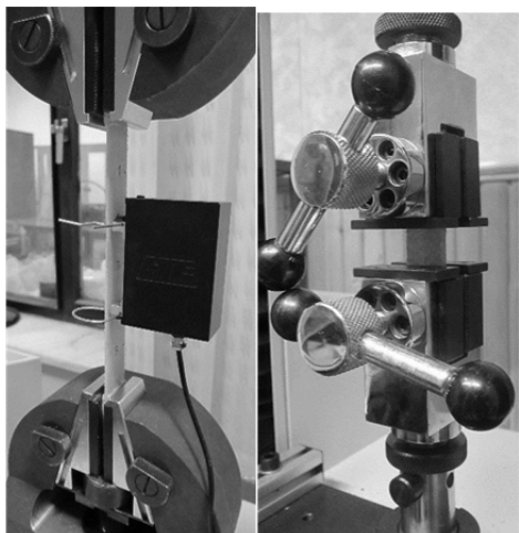
شکل ۵) آزمون‌های فشار (سمت راست) و کشش (سمت چپ)
