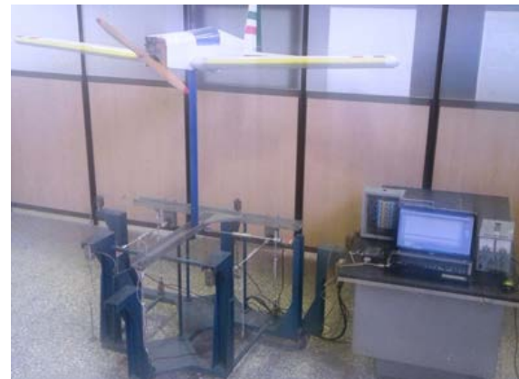
شکل ۴) تصویر مجموعه بالانس تونل باد طراحی شده
