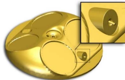
شکل ۲) سرسیلندر اصلاح یافته موتور تزریق مستقیم
