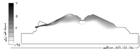
شکل ۴) نسبت هم‌ارزی مخلوط داخل سیلندر در لحظه اتمام پاشش ثانویه در حالت پاشش الف
