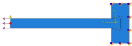
شکل ۴) نمایش مدل پره و دیسک و شرایط مرزی اعمال شده بر آن در محیط نرم‌افزار آباکوس
