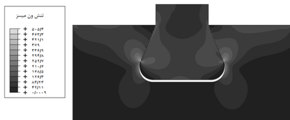
شکل ۷) توزیع تنش ون میسر در اثر اعمال بار محوری و خمشی به‌طور هم‌زمان در حالت اول (برحسب مگاپاسکال)
