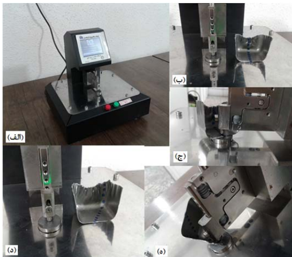
شکل ۴) الف) دستگاه ضخامت سنج دقیق ب) مسیر طولی اندازه گیری ج) اندازه گیری ضخامت در راستای طولی د) مسیر قطری اندازه گیری ه) اندازه گیری ضخامت در راستای قطری
