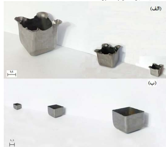
شکل ۹ ورق‌های کشیده‌شده برای (الف) ورق دایره‌ای (ب) ورق مربعی
