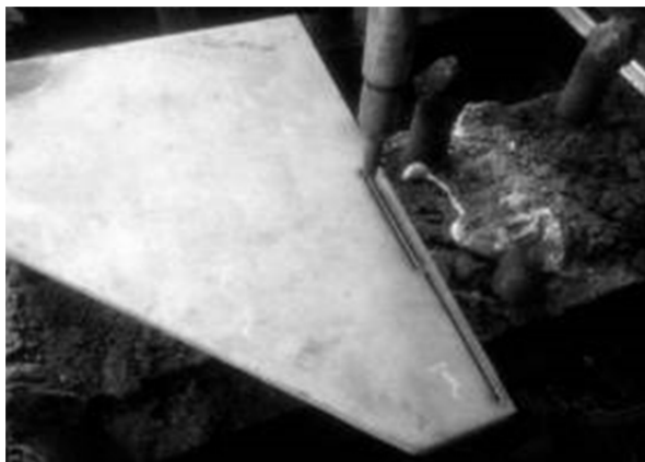
شکل (۱) برش پلازما ورق فولاد ضد زنگ AISI۳۰۹
