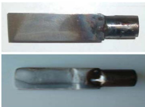
شکل ۳) سطح نمونه قبل و بعد از آزمایش در محلول حاوی پودر سیاه و الکل در 4500 \text{ rpm}
