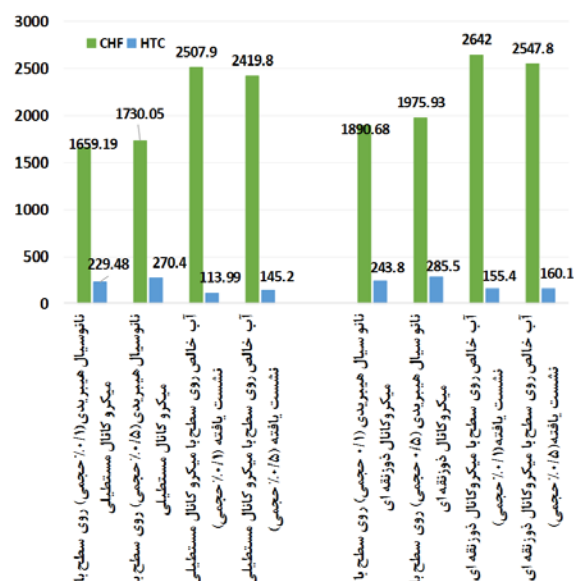
نمودار ۱۵) نمودار میله‌ای مقایسه نتایج نهایی آزمایشات جوشش و نشست نانوسیالات هیبریدی روی سطوح میکروکانال‌شده
