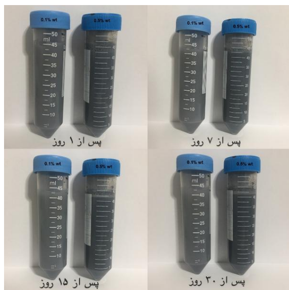
شکل (۵) تست نشست ذرات در نانوسیال MWCNT (OH)-TiO 2 با غلظت‌های حجمی ۰/۱ درصد و ۰/۵ درصد
