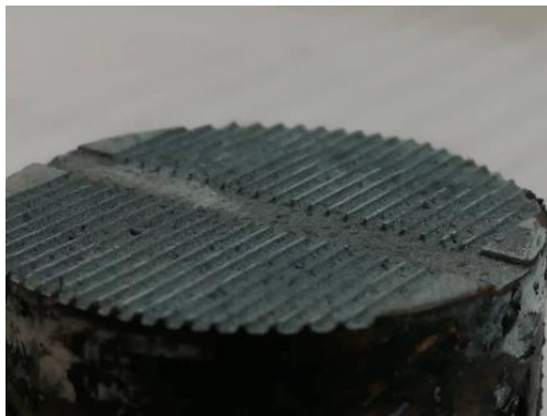
شکل ۱۰) سطح با میکروکانال مستطیلی نشست‌یافته
