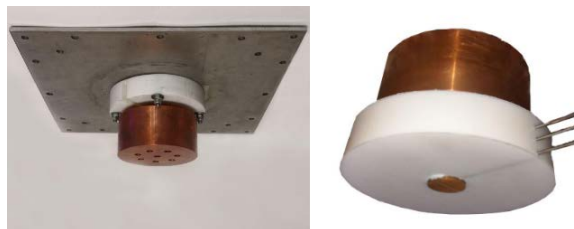
شکل (۴) نحوه قرارگیری PTFE دور کارتریج مسی به همراه ترموکوپل‌ها
