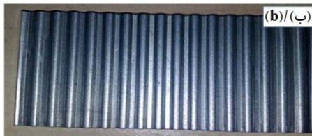
شکل ۳) تصاویر (الف) قالب SCGP و (ب) نمونه ورق یک مرتبه SCGP شده IF فولاد
