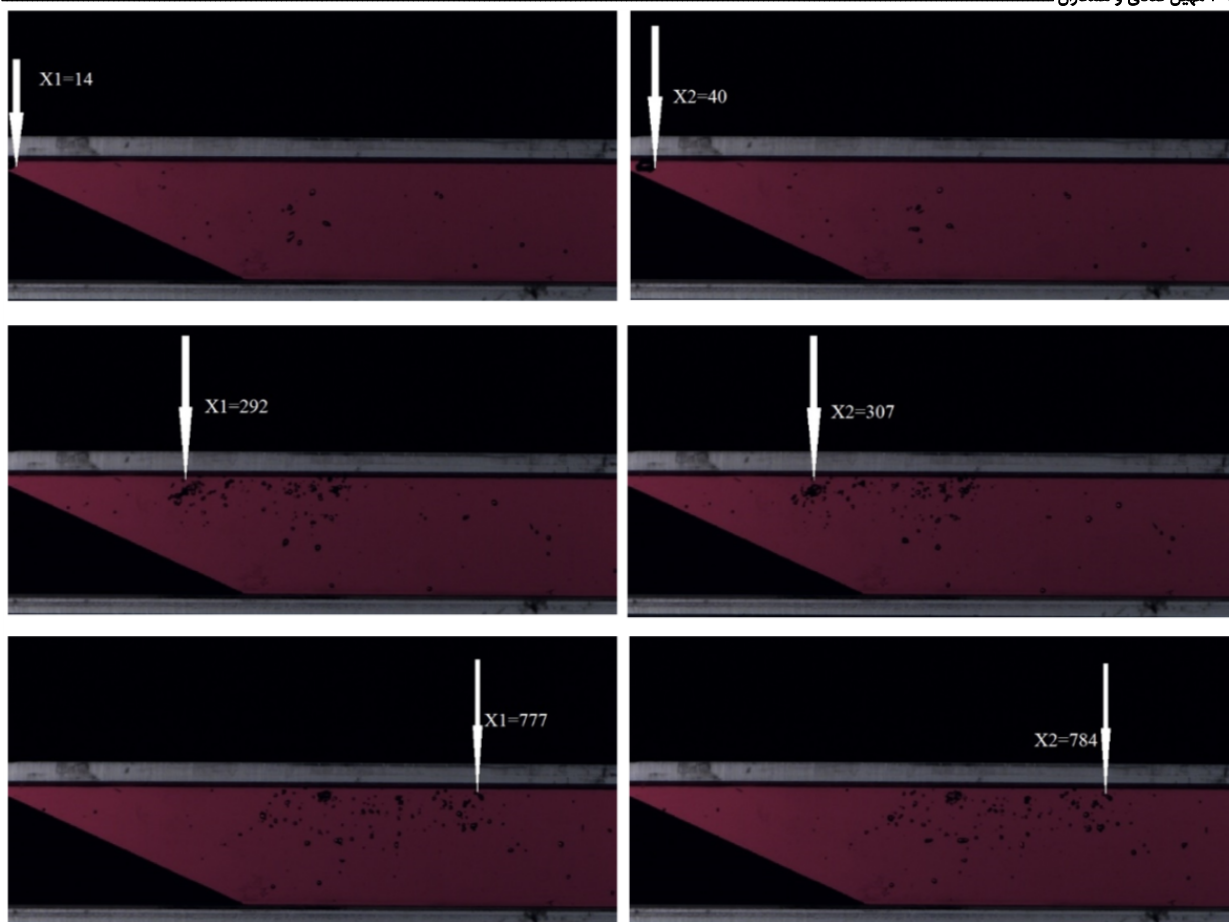
شکل ۳) ردیابی حباب‌ها در زمان‌های مختلف در مرکز لوله ونتوری برای محاسبه سرعت در مدل شماره ۲ با دبی ۰/۱۶ لیتر بر ثانیه
