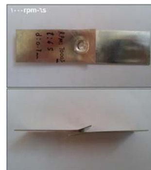
شکل ۸) تصویر ماکروسکوپی از نمونه جوشکاری شده در سرعت دوران ۱۰۰۰rpm و زمان دوران ۶s بعد از آزمون کشش برش
