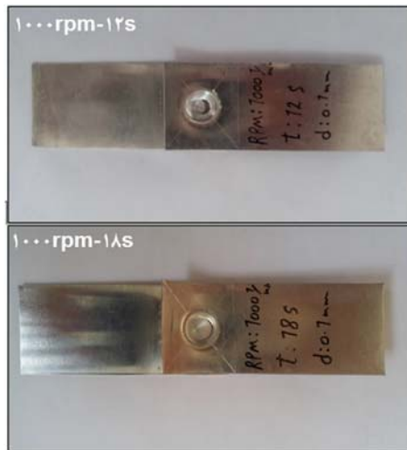
شکل ۷) تصویر میکروسکوپی از نمونه‌های جوشکاری شده در سرعت ۱۰۰۰rpm و زمان‌های دوران ۱۲ و ۱۸S بعد از آزمون کشش برش
