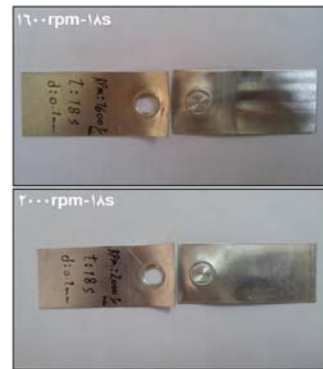
شکل ۱۰) تصویر ماکروسکوپی از نمونه‌های جوشکاری شده در زمان دوران ۱۸S و سرعت‌های دوران ۱۶۰۰rpm و ۲۰۰۰rpm
