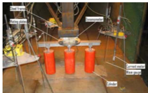
شکل ۱) مدل آزمایشگاه در فلوم مرکز هیدرولیک کانادا جهت اعتبارسنجی نتایج [16]
