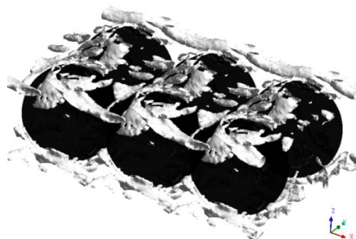
شکل ۵) ساختارهای گردابه‌ای تشکیل شده در محیط متخلخل با ساختار چینش منظم کروی (تکرار گرافیکی یک حفره)
