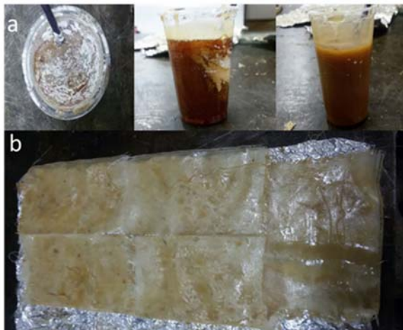
شکل ۱) اختلاط میکروذرات تالک با رزین فنولیک (a) و پیش‌آغشته‌های B- استیج شده (b)
