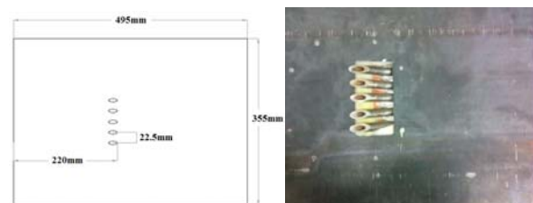
شکل (۲) صفحه تست به‌همراه ابعاد و سوراخ‌های تزریق
