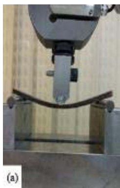
شکل (۵) آزمایش خمش سه نقطه‌ای روی پنل ساندویچی با هسته a: فوم معمولی و b: فوم اکستیک
