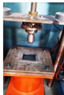
شکل ۱۰) آزمایش ضربه روی پنل ساندویچی
