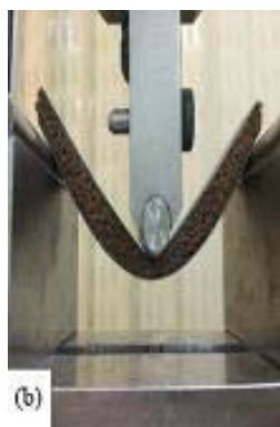
شکل (۵) آزمایش خمش سه نقطه‌ای روی پنل ساندویچی با هسته a: فوم معمولی و b: فوم اکستیک
