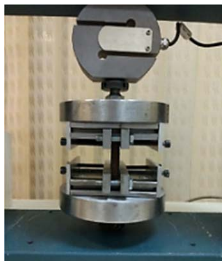
شکل ۶) آزمایش فشار لبه‌ای روی پنل ساندویچی
