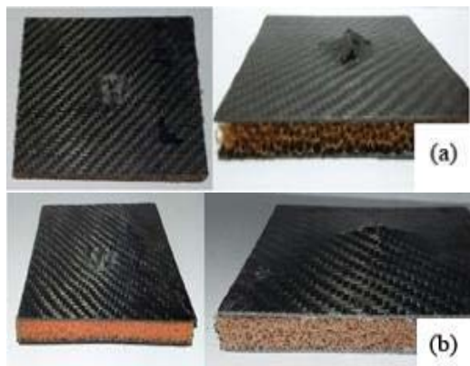
شکل ۱۱) پنل ساندویچی با هسته فوم معمولی (a) و اکستیک (b) تحت بار ضربه
