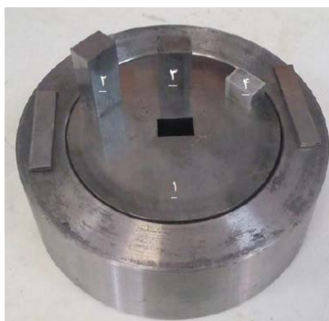
شکل ۱) تصویر قالب MDF و سنبه‌های تهیه‌شده برای پژوهش حاضر (۱- قالب، ۲- سنبه بزرگ، ۳- سنبه کوچک و ۴- نمونه)
