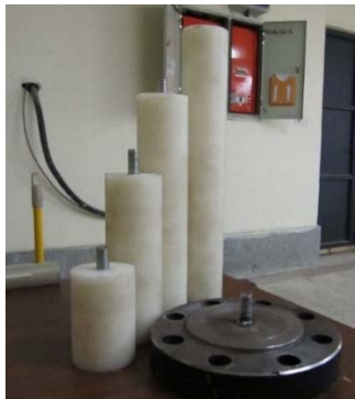
شکل ۳) فیلرهای لوله شوک برای تغییر طول موثر محرک
