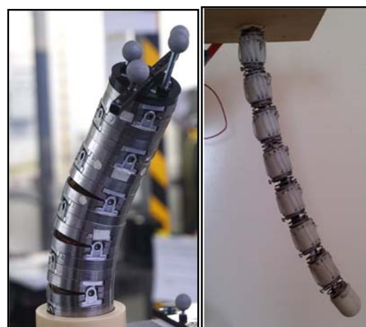
شکل (۴) (الف) بازوی هشت بسته‌ای با تحریک اس‌ام‌ای دو حالته طراحی شده برای استفاده به‌جای لوله اندوسکوپی [11] ، (ب) بازوی ده بسته‌ای با تحریک الکترومغناطیسی دو حالته [12]
