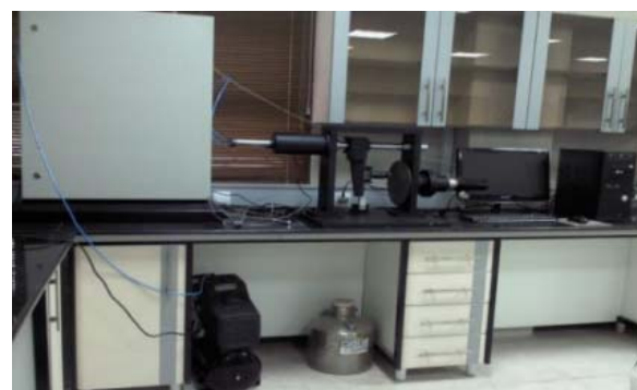
شکل ۱۳) دستگاه تست مقاومت سایشی پین روی دیسک
