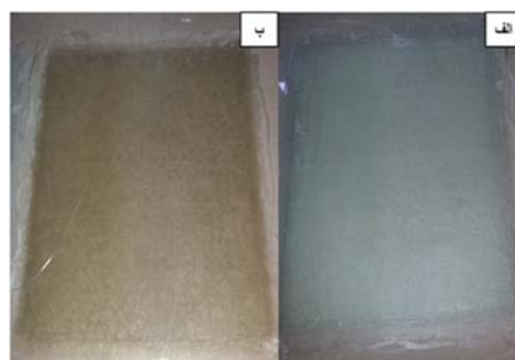
شکل ۳) لمینیت پخته شده حاوی پودر نانو (الف) و بدون پودر نانو (ب)
