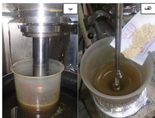
شکل ۱) ترکیب پودر نانو توسط دستگاه همزن اولتراسونیک
