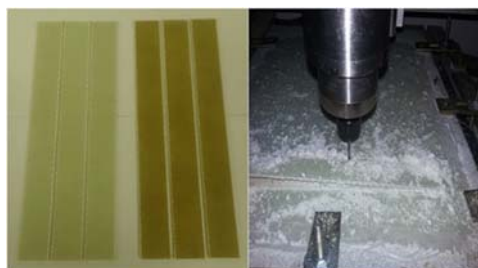
شکل ۴) برشکاری نمونه‌های کپن تست برای آزمون کشش توسط دستگاه CNC
