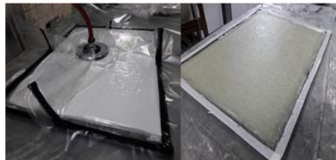
شکل ۲) ساخت لمینیت کامپوزیت
