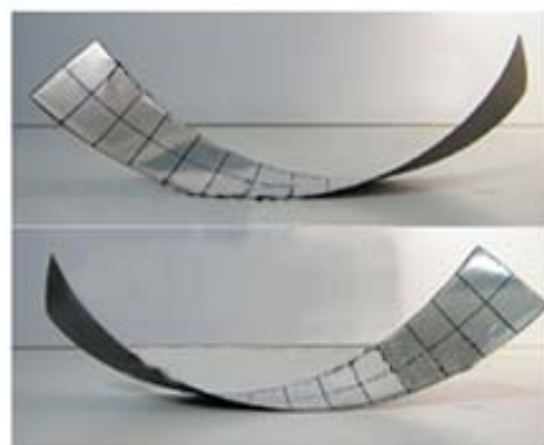
شکل ۲) حالت‌های پایدار ورق مرکب دوپایا با چینش [0_n/90_m]_T [28]
