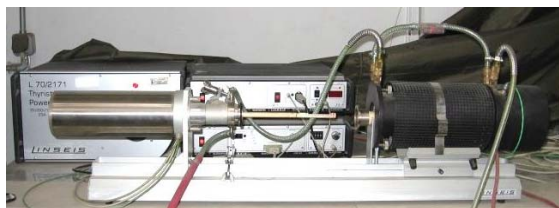
شکل ۵) دستگاه دیلاتومتری افقی استفاده شده
