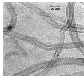
شکل ۷) تصویر میکروسکوپ الکترونی عبوری (TEM) نانولوله‌های کربنی مورد استفاده
