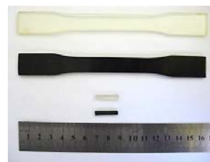
شکل ۸) تصویر نمونه‌های آزمون کشش و دیلاتومتری (از بالا به پایین: نمونه آزمون کشش بدون نانولوله کربنی، نمونه آزمون کشش با نانولوله کربنی، نمونه آزمون دیلاتومتری بدون نانولوله کربنی، نمونه آزمون دیلاتومتری با نانولوله کربنی)
