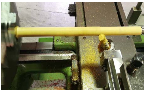
شکل (۵) نمایی از عملیات تراشکاری نمونه‌ها با استفاده از ابزار خودچرخان
