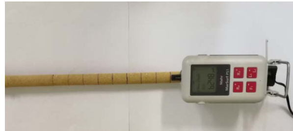
شکل ۱۶) نمایی از نحوه اندازه‌گیری زبری نمونه‌ها با دستگاه زبری‌سنج
