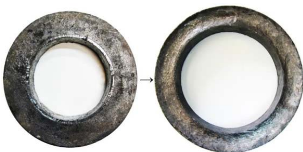
شکل ۱۱) الف) حلقه ریخته‌گری شده (حلقه شماره ۰۰، ب) حلقه نورد شده با سرعت دورانی غلتک اصلی ۲۰ RPM و سرعت خطی مندرل ۰/۶ mm/s (حلقه شماره ۴)
