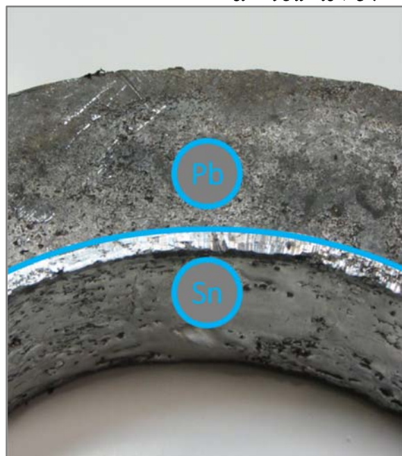
شکل ۸) نمایی نزدیک از حلقه دولایه و نمایش جنس لایه‌های آن
