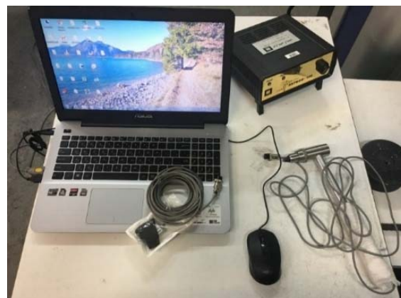
شکل ۸) نمونه‌ای از تجهیزات آنالیز مودال
