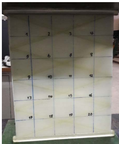
شکل ۹) شبکه‌بندی نمونه برای انجام آنالیز مودال
