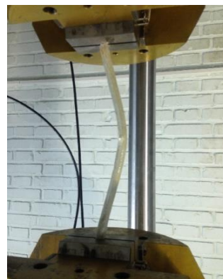
شکل ۳) ستون تقویت شده با کمر بند کامپوزیتی پس از کماتش
