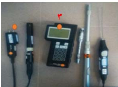
شکل ۳) وسایل اندازه‌گیری مورد استفاده؛ ۱- دیتالاگر، ۲- پیرانومتر، ۳- ۴۵۴ testo
