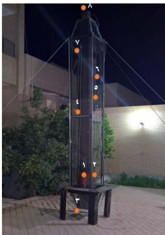
شکل ۱) تهویه ساز خورشیدی و نقاط مختلف اندازه گیری سرعت و دما
