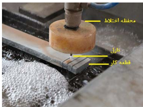
شکل ۶) نحوه برش نمونه ها توسط جت آب و ذرات ساینده
