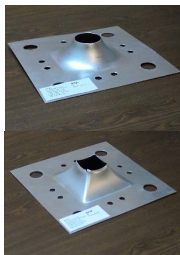
شکل ۵) فلنچ هرمی با سوراخ 30 \times 30 میلی‌متر و فلنچ مخروطی با سوراخ به قطر 30 میلی‌متر
